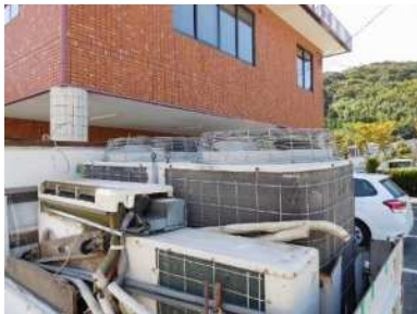
R22 冷媒のエアコン 10 台廃棄
